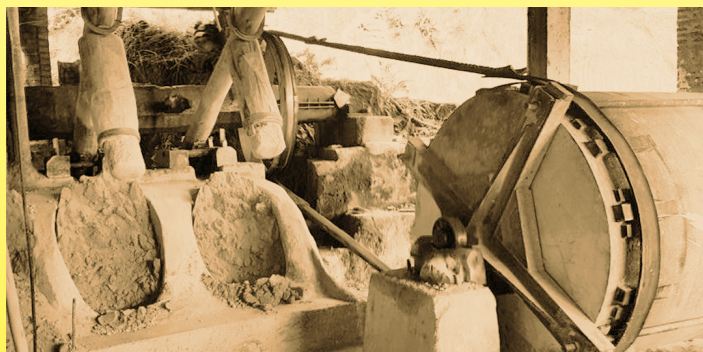
传统的生产机械(水碓)，生产用于制作电高频瓷的粉末 (私人收藏)
